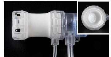
*Figura 2.* Válvula após a pressurização
